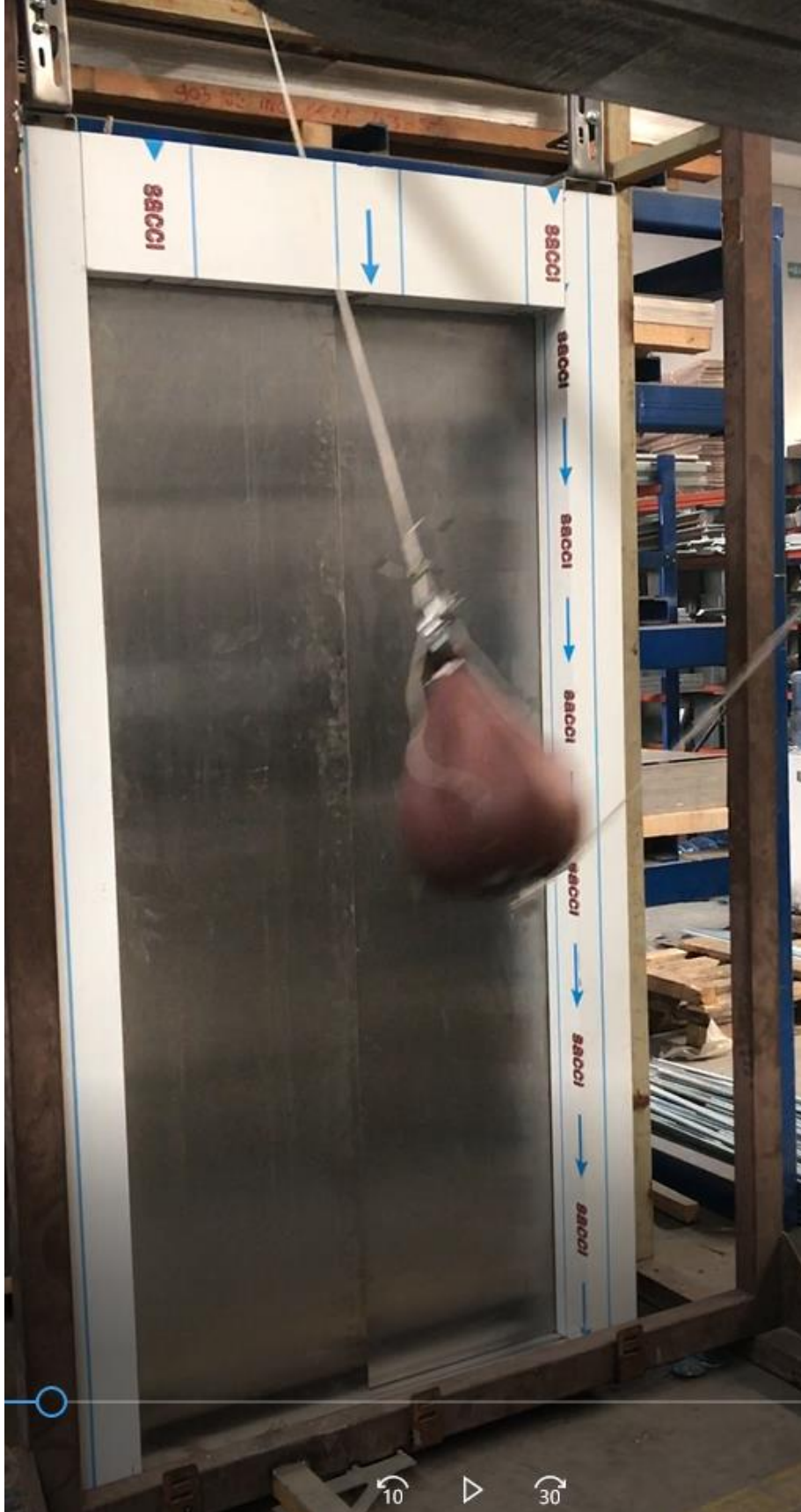
Resim 6: H=800 mm yumuşak darbe deneyi
