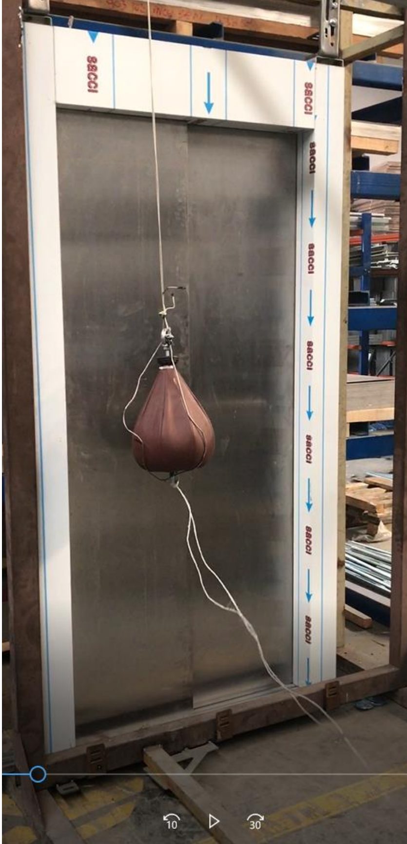
Resim 7: H=800 mm yumuşak darbe deneyi sonrası görüntü
