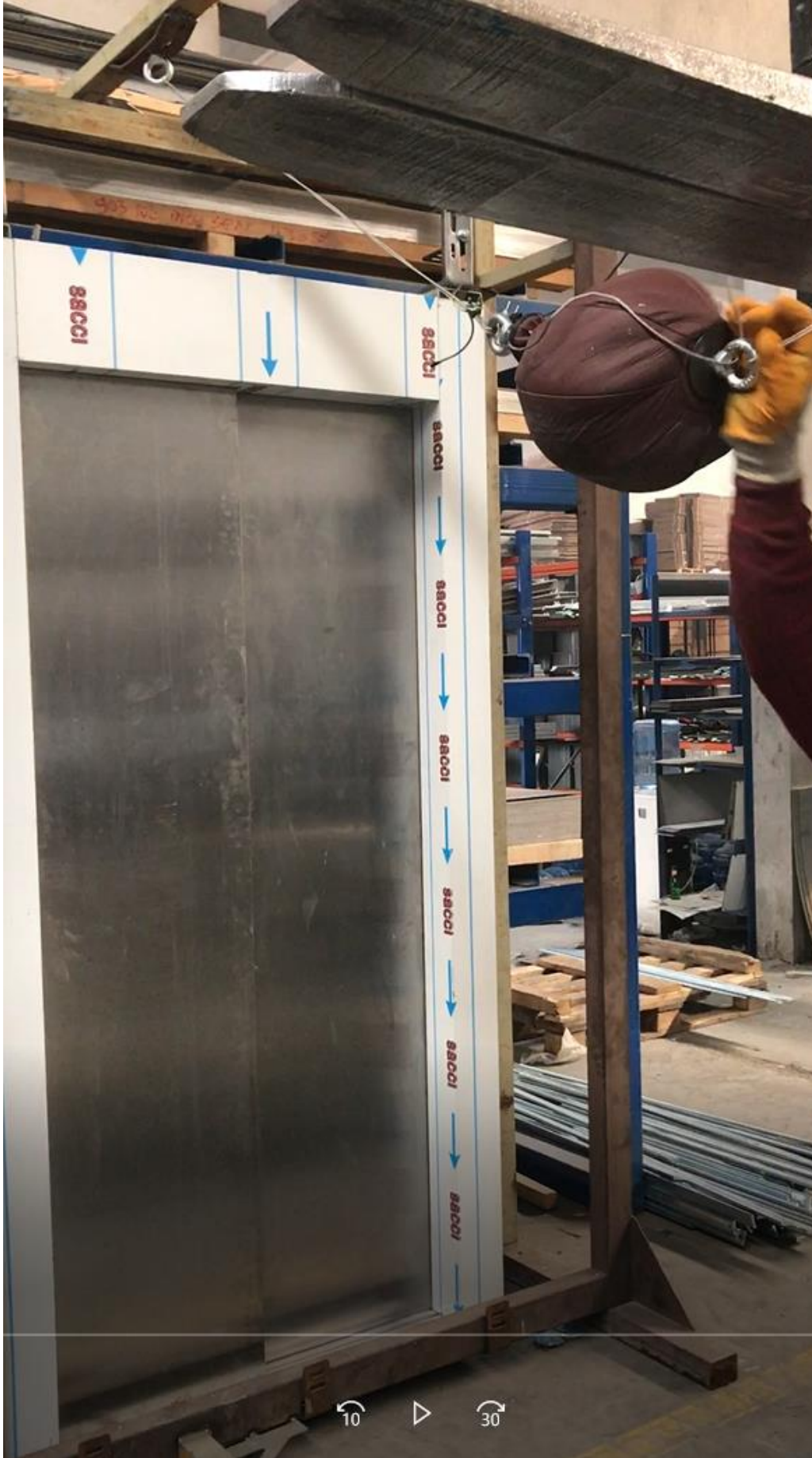
Resim 5: H=800 mm yumuşak darbe deneyi öncesi
